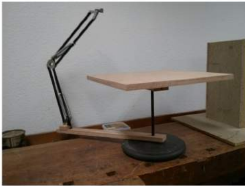
Eine mögliche Konstruktion für den 3D-Scanner: eine alte Stehlampe und eine Bürolampe
