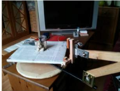
Am umgedrehten Drehteller wird eine Halterung montiert, an der wiederum ein beweglicher Arm mit Halterung für das Smartphone
