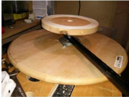
Am umgedrehten Drehteller wird eine Halterung montiert, an der wiederum ein beweglicher Arm mit Halterung für das Smartphone
